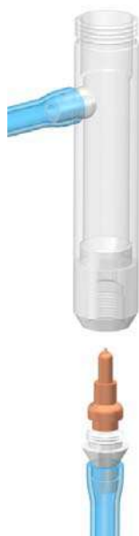
Рис. 4.5. Установка обратного клапана в ИКПЖ
