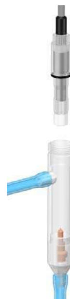
Рис. 3.9. Установка АСрН 2 в измерительную камеру.
